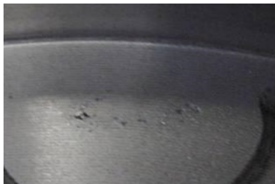
2. ábra: A súrlódó felület fellazult szövetszerkezete
