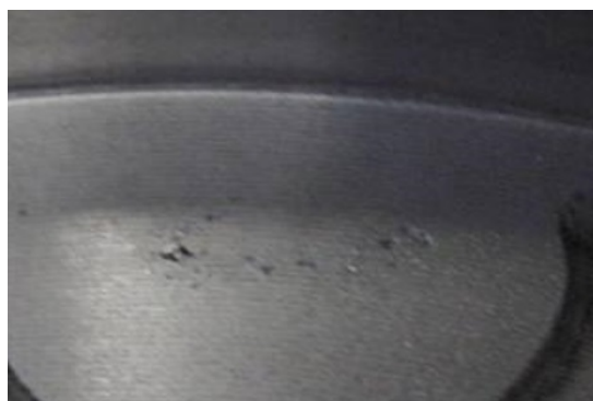
2. ábra: A súrlódó felület fellazult szövetszerkezete
