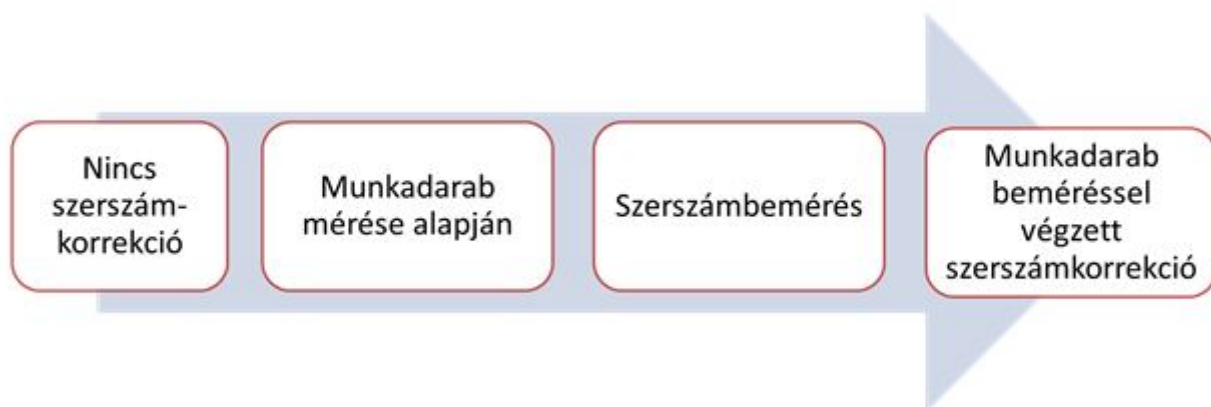
3. ábra: Szerszámkorrekciózás szintjei
