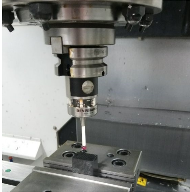
1. ábra: Mérőtapintó működés közben
